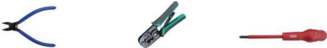
Verwenden Sie isolierte Werkzeuge, um versehentlichen elektrischen Schlag oder Kurzschluss zu vermeiden. Wenn kein Isolierwerkzeug vorhanden ist, verwenden Sie Isolierband, um alle freiliegenden Metalloberflächen des Werkzeugs für die Isolierbehandlung abzudecken.
